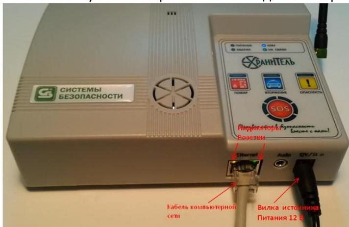
Прибор автоматически получит адрес в локальной сети пользователя, выйдет в интернет, свяжется с сервером дата-центра и получит необходимые настройки. Прибор активизирован и готов к работе.
