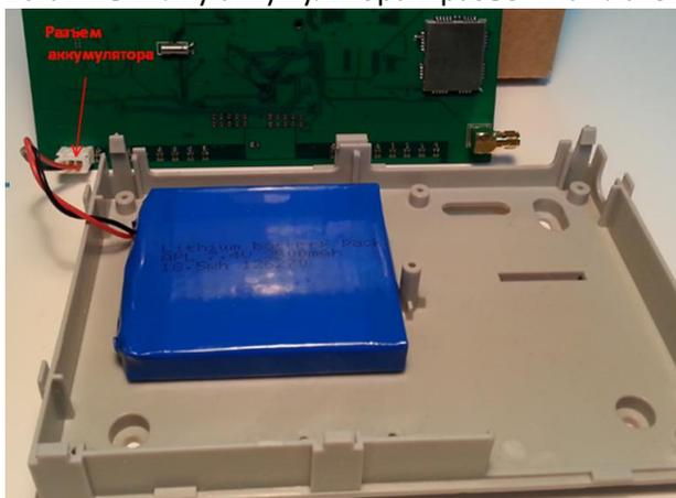
5. Закрепить основание прибора саморезами, используя четыре отверстия на днище к поверхности, где будет эксплуатироваться прибор.
